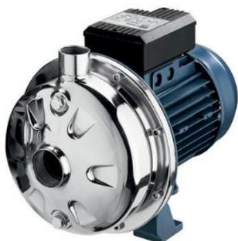
Центробежный насос с одиночным радиальным рабочим колесом, гидравлическая часть которого выполнена из нержавеющей стали AISI 304 или AISI 316, в том числе холодной штамповкой водой с давлением до 1200 бар (модель L), что обеспечивает высокий уровень прочности и надежности при низких гидравлических потерях.
