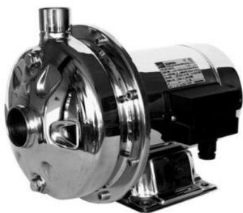
Центробежный насос, выполненный полностью из нержавеющей стали AISI 304, с одиночным рабочим колесом и 2-полюсным асинхронным двигателем с внутренним воздушным охлаждением.
